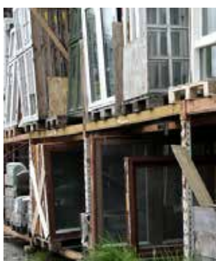
Soteringsreol, genbrug af byggematerialer
